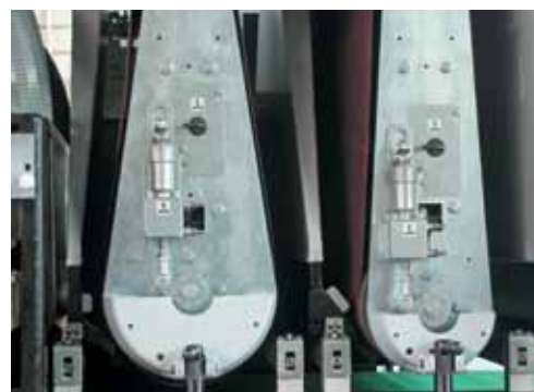
Rullo di contatto con diametro di 240 mm o 320 mm Rodillo de contacto con diametro 240 mm o 320 mm
