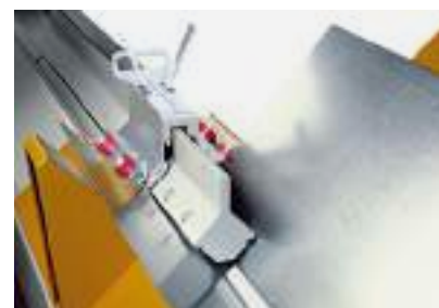
Autopilot e barra aggraffatrice rinforzata nella DuctZipper RAS 20.12.
