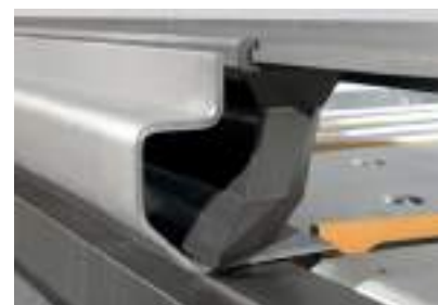
Utensile ganascia superiore con grande spazio libero sul lato anteriore.
