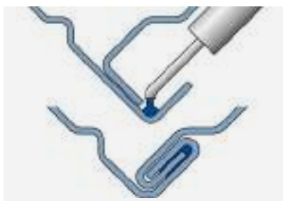
Piegatura per canali con gel sigillante integrato per le massime esigenze di tenuta.
