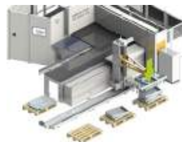
Impilamento orizzontale di un pezzo piegato su un pallet
