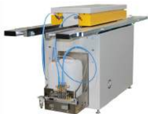
SpeedySeamer con dispositivo a spruzzo per la lavorazione dell'acciaio inossidabile.
