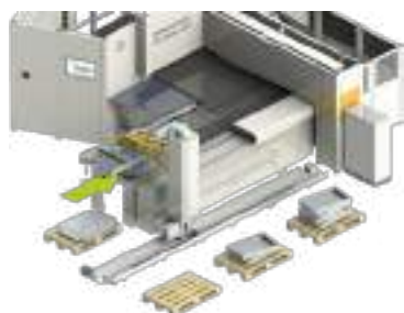
Separazione e caricamento di un formato sagomato con il sistema di caricamento RAS Palletizer
