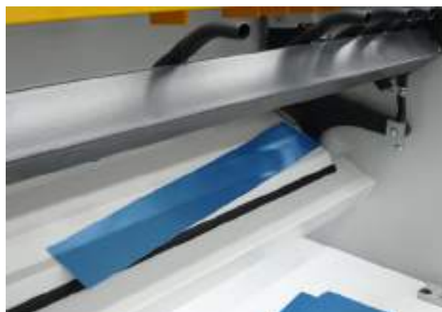
Il deviatore fa cadere le strisce sottili verso il retro.
