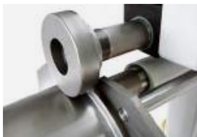
Rulli di bordatura FL: per flangiare mantenendo il tubo orizzontale.
