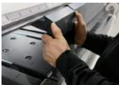
Operazioni di allestimento veloci grazie al serraggio automatico degli utensili.
