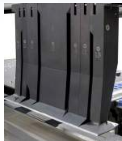
Utensili ganascia superiore fino ad un'altezza di 600 mm.
