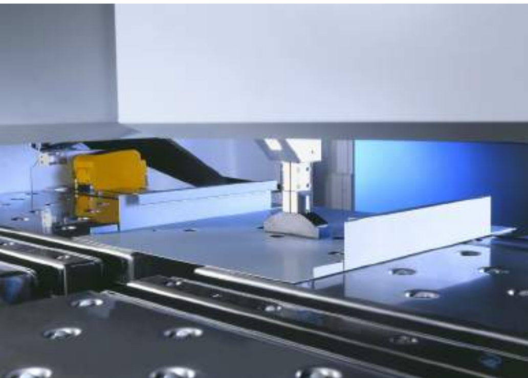
Manipolatore per la rotazione e il posizionamento dei pezzi piegati
