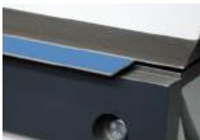
Regolazione automatica dell'utensile di piega in base allo spessore della lamiera.
