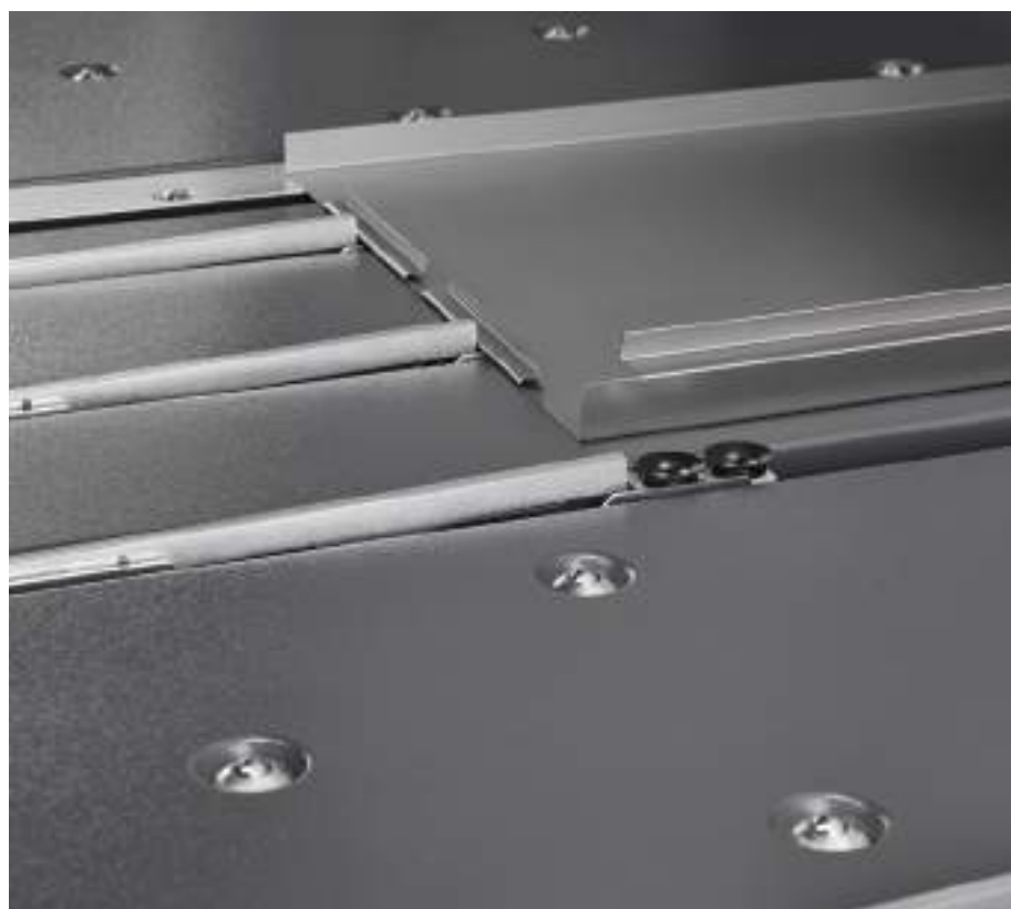
Le ventose del sistema di posizionamento ibrido trattengono la parte piegata per l'intera sequenza di piega
