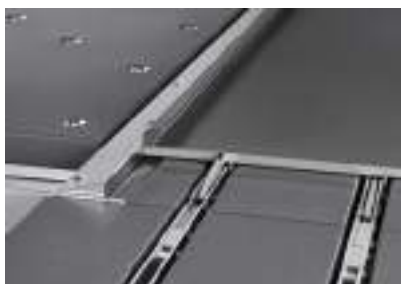
Allineamento sicuro di pezzi da piegare lunghi e stretti grazie alla battuta angolare attiva.
