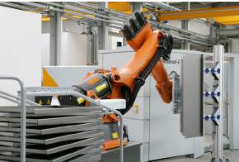
Stazione di ribaltamento lamiera per pezzi finiti
