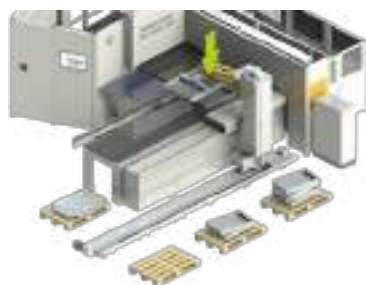
Prelievo del pezzo piegato mediante dispositivo di presa ad aspirazione del palettizzatore
