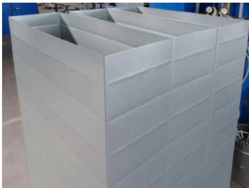
Una migliore qualità della piega consente di ridurre la distorsione della sezione trasversale del condotto.
