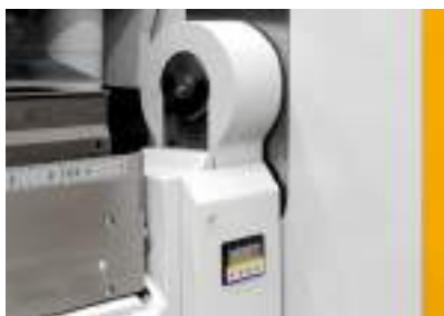
Visualizzazione digitale opzionale per la regolazione della bandiera di piega.
