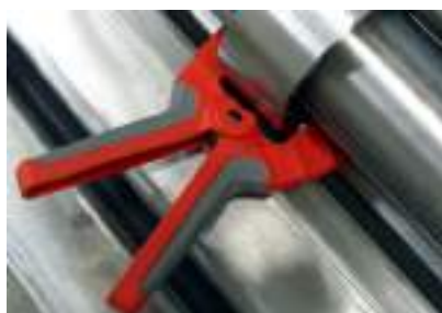
La pinza di presa riduce una flessione degli alberi.
