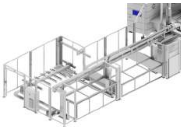
Caricamento a portale a due posti con SheetFlipper per voltare gli sviluppi.
