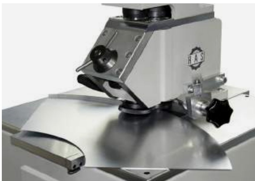
Guida Produzione curve per le condotte d'aria. automatica della lamiera
