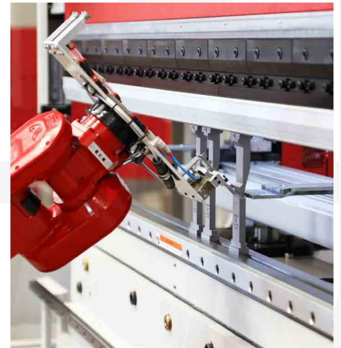
La TK MINIBEND CELL di Schiavi Macchine è una soluzione innovativa e compatta per l'automazione della piegatura di pezzi di piccole e medie dimensioni, garantendo massima efficienza, precisione e flessibilità. Questa cella, caratterizzata da un design salvaspazio, è dotata di componenti standard che assicurano elevata produttività e qualità:
